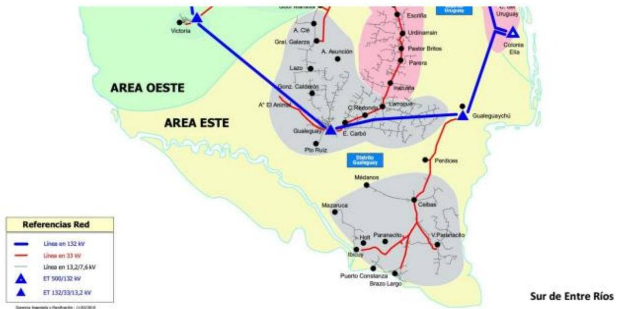
En las barras de Gualeguaychú, Gualeguay y Victoria existen compensación de reactivo (inyección) para mejorar los perfiles de tensión de las mismas, los valores de los capacitores instalados son de 4,8 MVAR para Victoria y de 16,6 MVAR para Gualeguaychú y 9,8 MVAR para Gualeguay; lo mismo ocurre para la barra de salida en 33 kV que alimenta este sistema, la cual posee una compensación de 4,8 MVAR.
