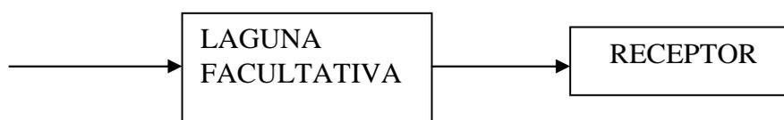
Con el propósito de obtener un mayor grado de depuración y un efluente de mayor calidad, se ha sugerido el uso de lagunas en serie. De esta manera se obtienen valores bajos de D.B.O. y un mínimo de bacterias patógenas.
