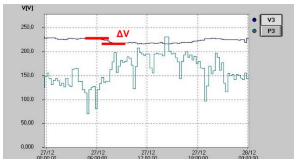
[fig.d] Potencia Activa - Tensión
