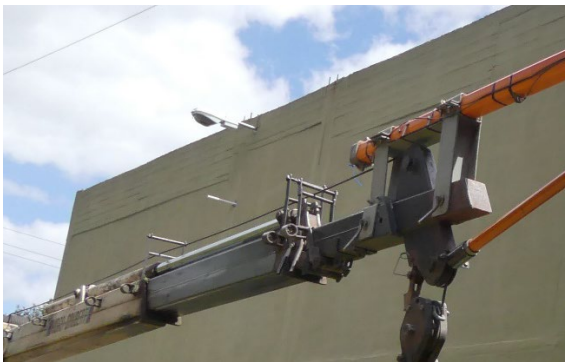
Fig. 5. Barra montada sobre grúa mediante caballete metálico de sujeción.
