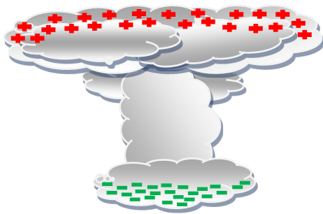
Fig. 1: Esquema de distribución de cargas eléctricas en una nube del tipo “Cumulonimbo”
