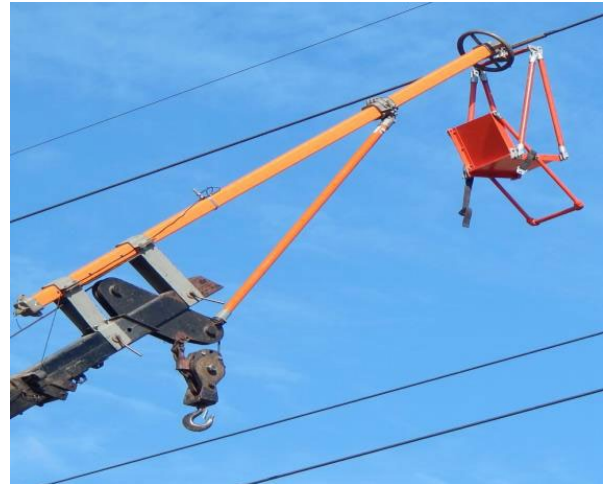
Fig. 2. Diseño EPE de extensión aislante para montar en grúa con barra de refuerzo, caballete de sujeción y sillín para operario.
