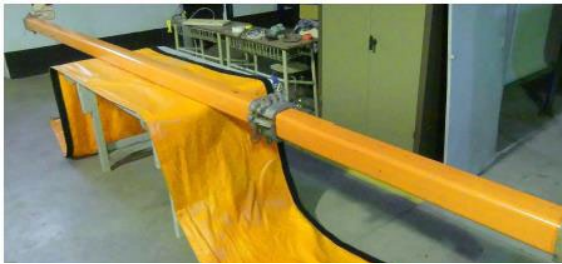
Fig. 4. Fotografía de barra para TcT de material FVRP inyectada de 5500 mm de longitud.
