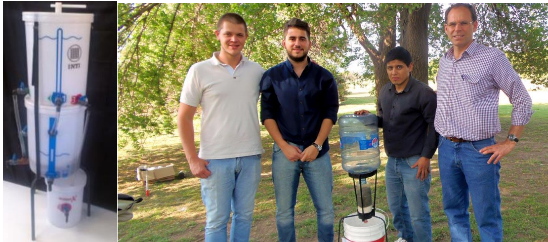
Figura 1: Izquierda, Dispositivo rural para abatimiento de arsénico realizado en INTI-Química. Derecha prototipo de adsorción de arsénico con filtro fácilmente reemplazable.
