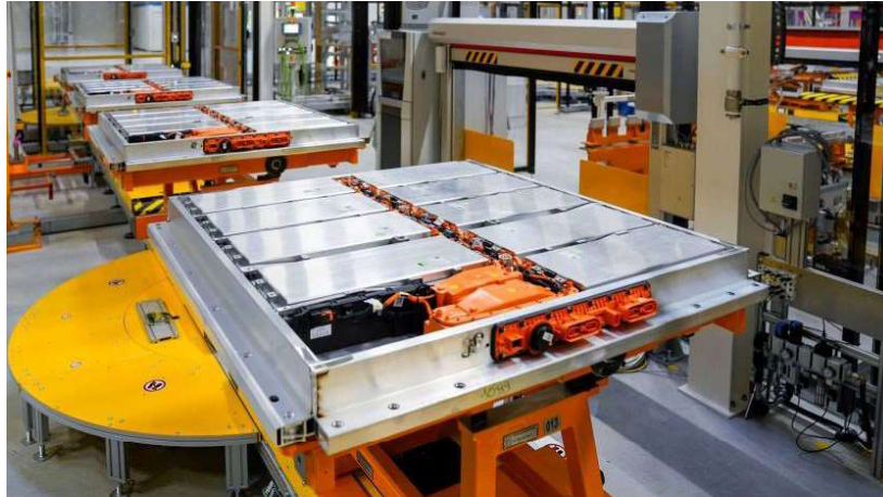
Ilustración 11: Imagen de banco de baterías de Volkswagen ID.3
