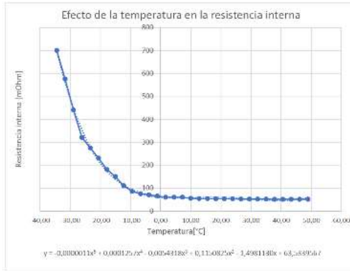
Ilustración 15: Relación entre resistencia interna y temperatura en la batería
