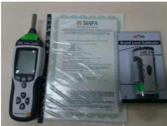
Foto 1: Sonómetro, Calibrador y Certificado de calibración
