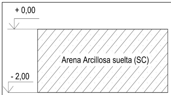
Figura N° 38: Modelo físico mecánico adoptado para el suelo.
