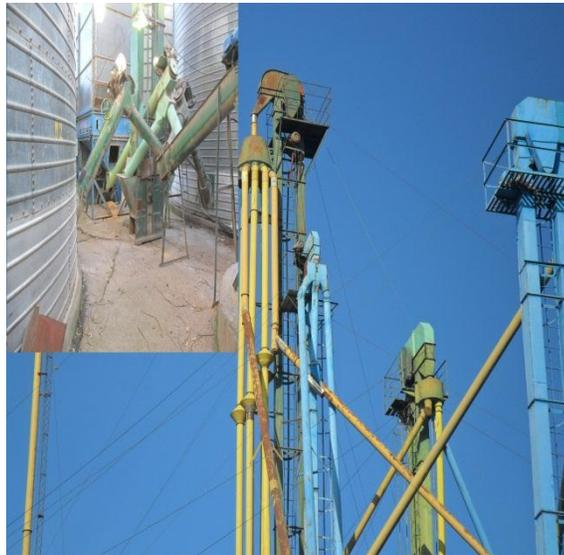
La cual se encarga de elevar el arroz a la parte superior de la secadora, donde por medio del calor que se produce por la combustión de la leña el cual es forzado por un par de turbinas que hacen circular el calor produciéndose el secado del grano. Dentro de la secadora se va moviendo la carga
