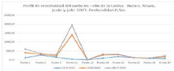
Figura N° 5.a: Perfil de Resistividad obtenidos en Avenida Félix de La Colina y Ruta Provincial N°5. Meses de mayo, junio y julio del 2023. Profundidades de 0,5m.
