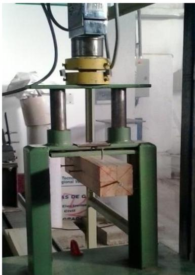
**Figura 3.** Dispositivo para ensayo.
