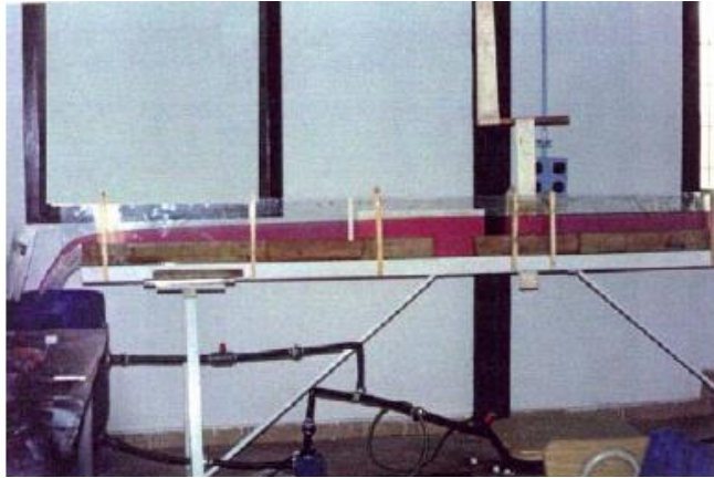
Figura 17: Pequeño canal hidráulico que se utilizó para los ensayos
