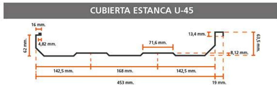
Figura 108: Detalle conformado U45 Fuente: insumasrl.com.ar
