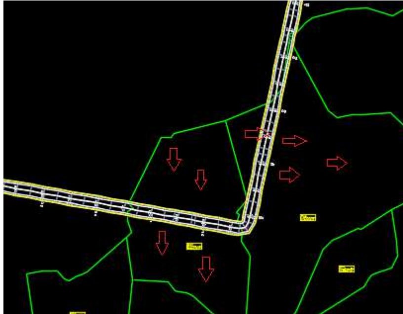
Figura 82: Esguerrimiento de cuencas que afectan el camino Fuente: Elaboración propia
