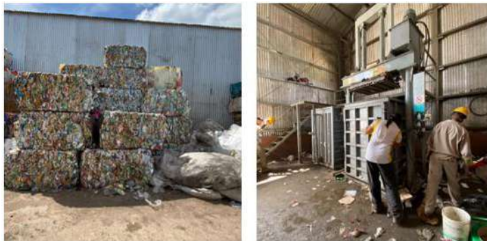
Figura 56: Compactación de RSU eco parque Gualeguaychú Fuente: Elaboración propia.
