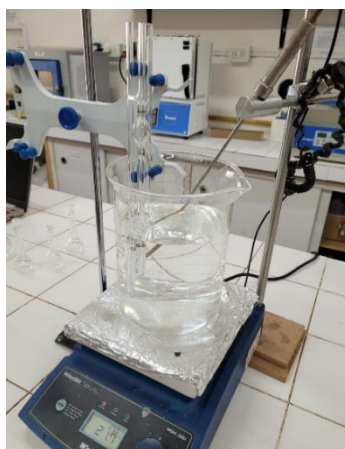
Figura 1. Sistema para la medición de \eta : viscosímetro Ubbelohde 1C en baño de agua. Resultados
