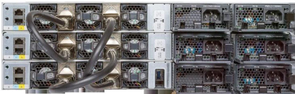
Figura 12 – Conexión SW Core [5]
