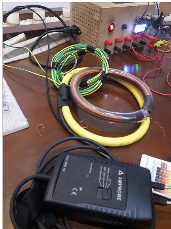
Figura 8 - Esquema para ensayar bobina Rogowski
