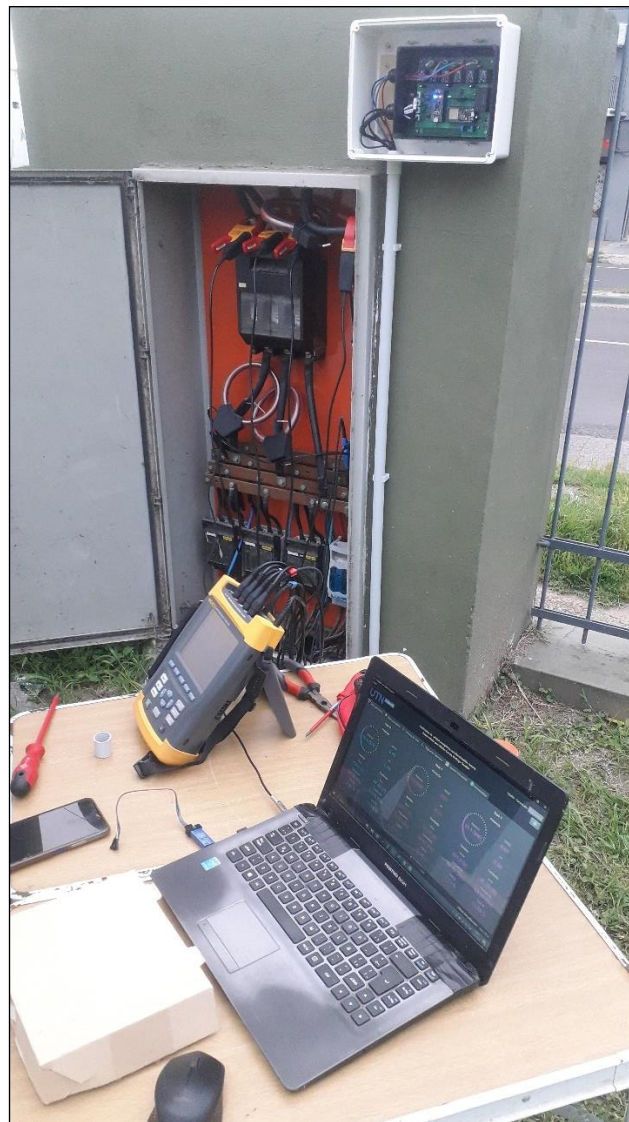
Figura 65 - Pruebas del equipo junto a un analizador comercial
