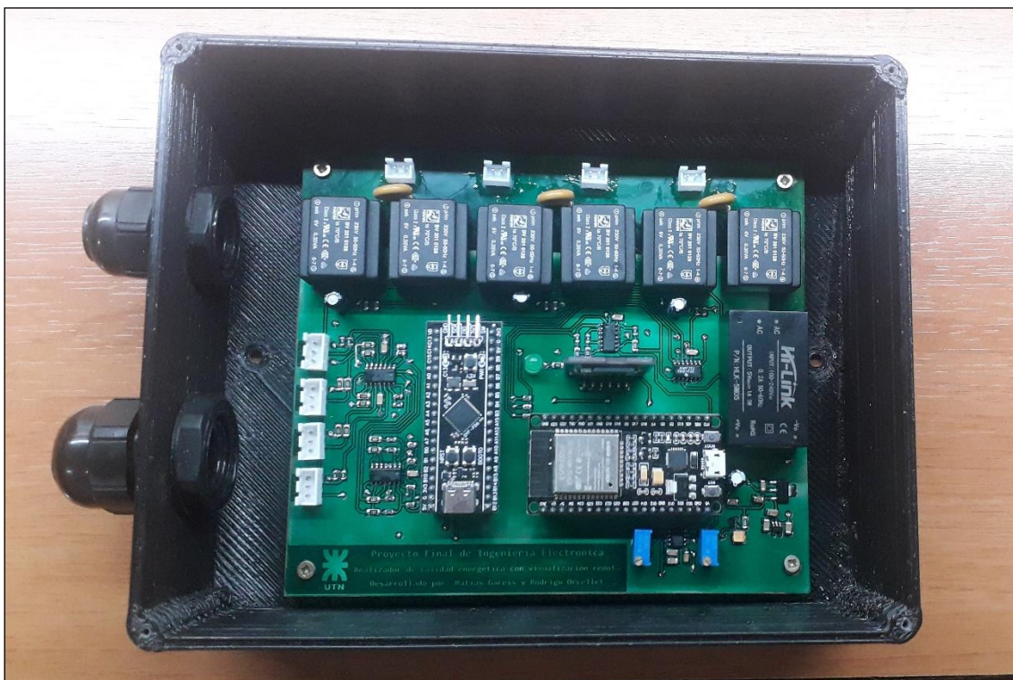
Figura 60 - PCB principal montada en gabinete impreso en 3D
