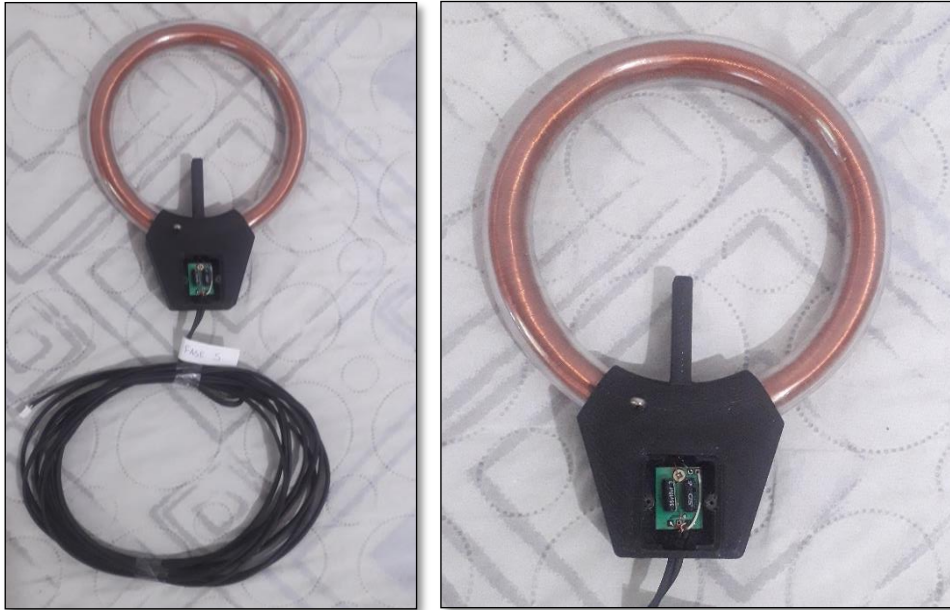
Figura 18 - Bobina Rogowski con soporte y PCB
