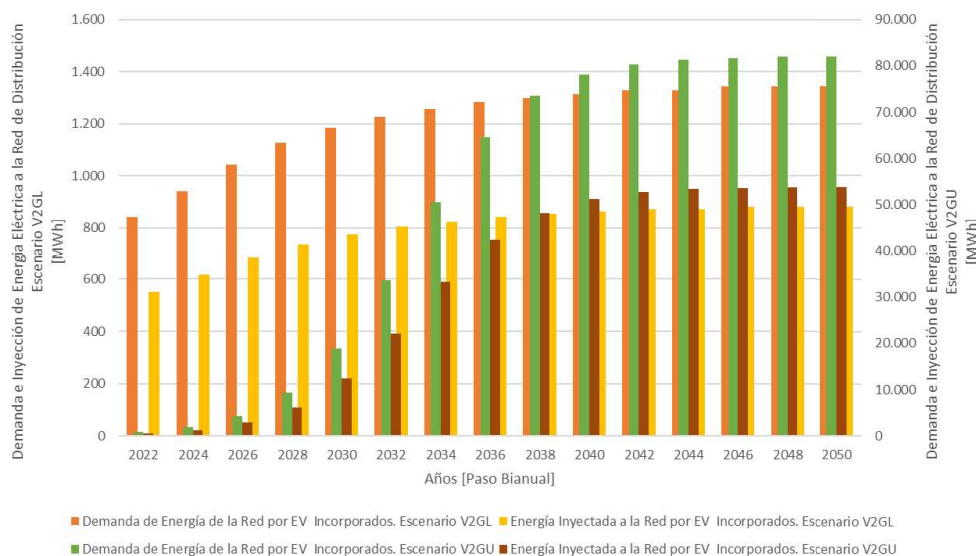
Figura 5: Demanda e Inyección de energía eléctrica a la red de distribución por los vehículos eléctricos incorporados al sistema energético de Mendoza. Escenario de baja penetración (V2GL) (eje izquierdo), escenario de alta penetración (V2GU) (eje derecho). Elaboración propia.
