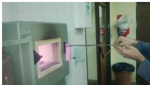
Figura 2 – Extracción de una probeta.
