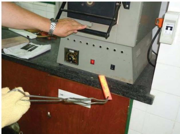
Fig. 2 Muestra sacada del horno a 1010°C
