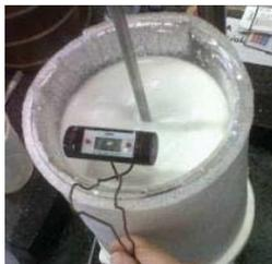
Fig. 1: Sistema experimental para apagado de cal
