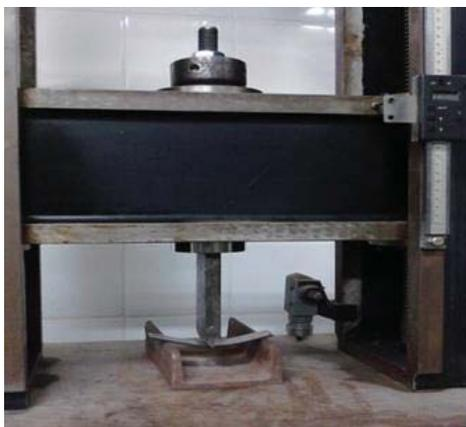
Fig.9 Probeta flexionada por el punzón
