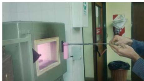
Figura 11 – Extracción de la probeta de la mufla.
