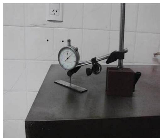
Fig.10 Comparador, medición de deformación
