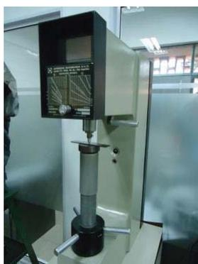
Fig. 4 Durómetro Rockwell.
