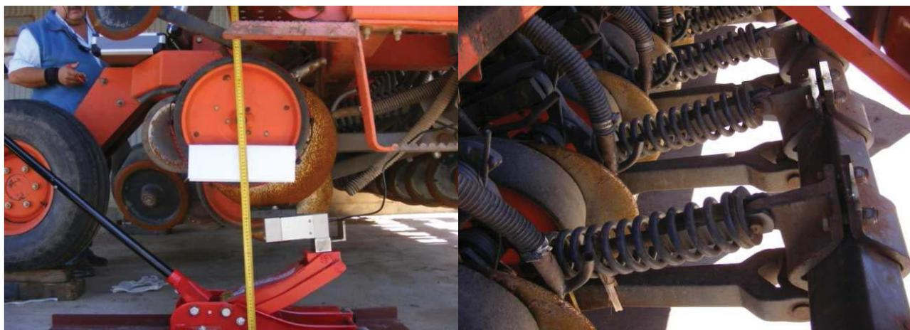
Figura N°4 – criquet y celda en posición de levante del tren – enganche de resorte monopunto.
