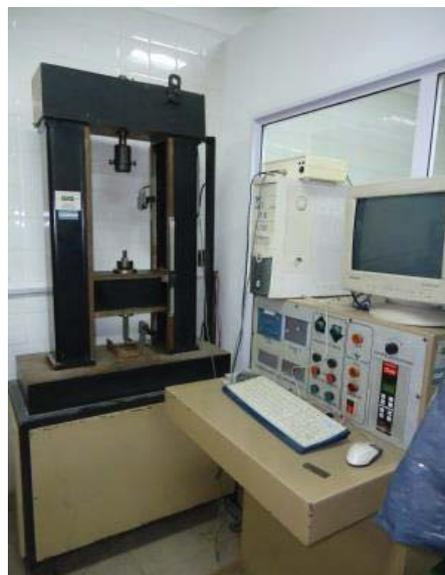
Fig. 8 Máquina de Tracción
