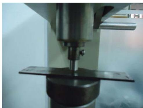
Fig. 5 Toma de dureza HRc
