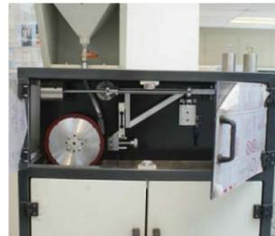
Figura 2 – Máquina de desgaste abrasivo [12]
