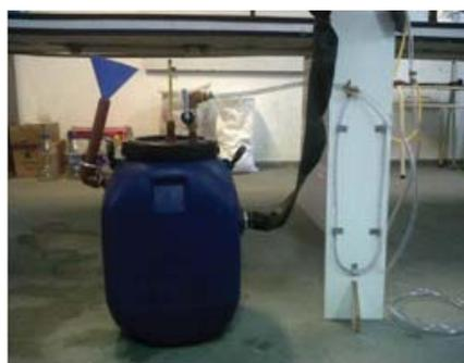
Figura 2: Biodigestor construido
