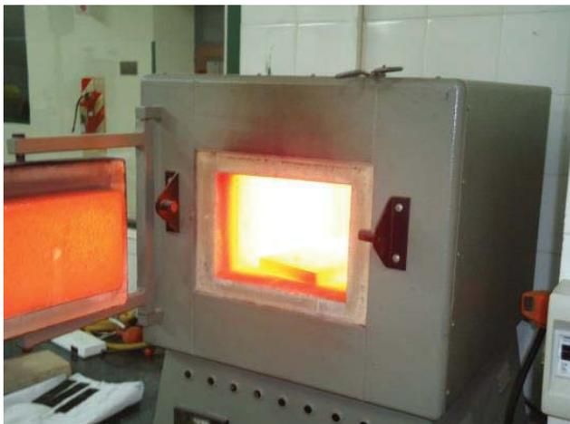
Fig. 1 Horno mufla a 1010 °C
