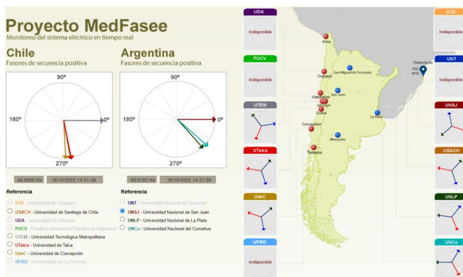
Figura 3-4 Interfaz sistema de medición MedFasee Conosur (medfasee.ufsc, 2003).
