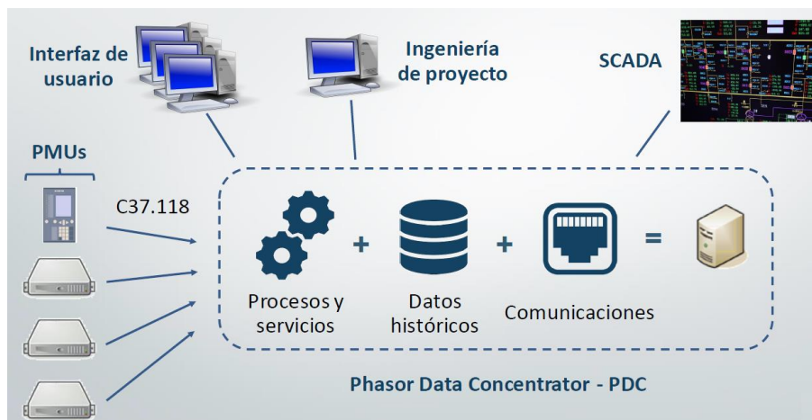
Figura 3-5 Arquitectura de un sistema de medición sincrofasorial (Amico, et al. 2020).
