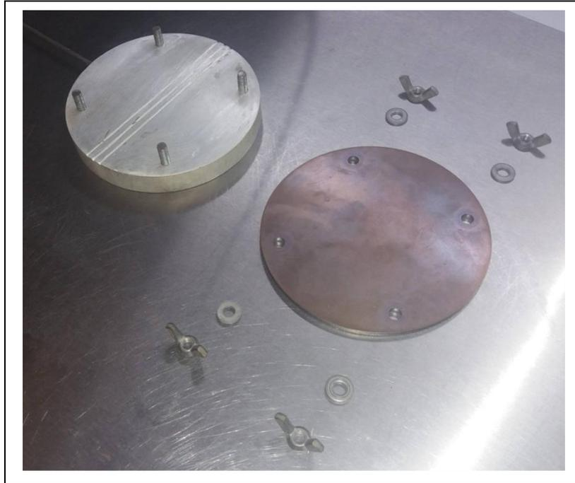
**Figura 4. 3.** Sistema empleado para realizar el tercer paso del procedimiento de deposición de la capa sensibilizadora sobre la LPG.
