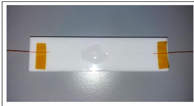
**Figura 3. 20.** LPG embebida en un líquido de índice de refracción conocido.
