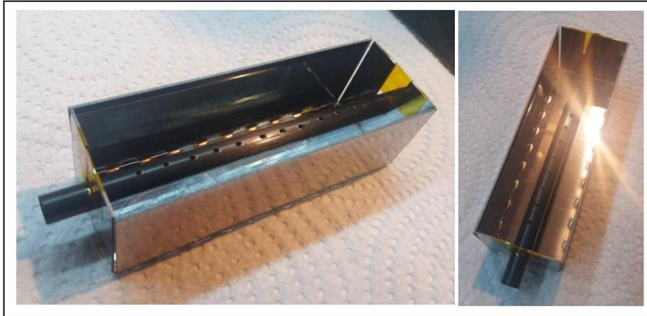
**Figura 5. 12.** Presentación del encapsulado de fibra de carbono en el molde.
