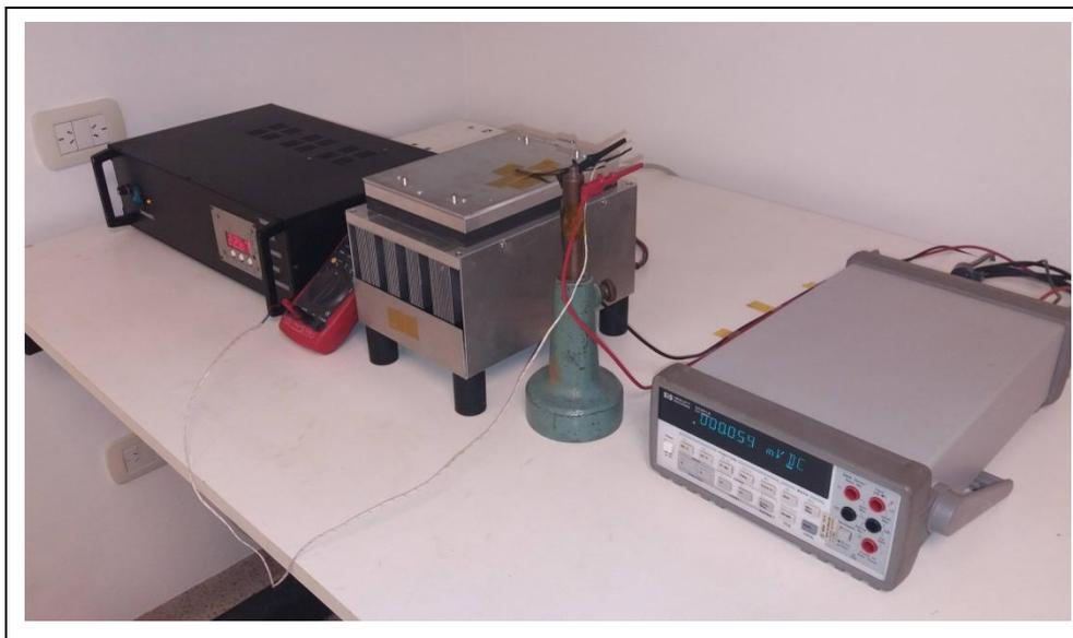
**Figura 4. 17.** Arreglo experimental montado para determinar la curva de calibración de la TC.
