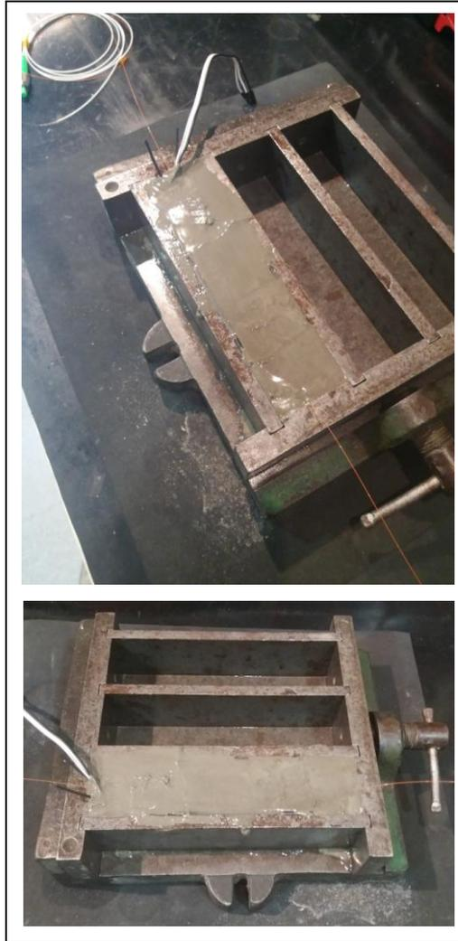
**Figura 5. 7.** Molde con la preparación en estado fresco. Se observan los accesos de los puertos de fibra óptica, los cables de la TC y el sensor de referencia.
