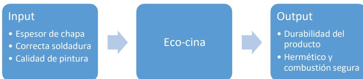
Dentro de los factores controlables encontramos espesor de chapa, soldadura correcta y calidad de pintura y dentro de los no controlables está la manipulación correcta de la eco-cina en relación a los golpes que esta pudiera sufrir y la activación manual del ventilador por parte del usuario cuando así lo quisiera para lograr una correcta combustión.
