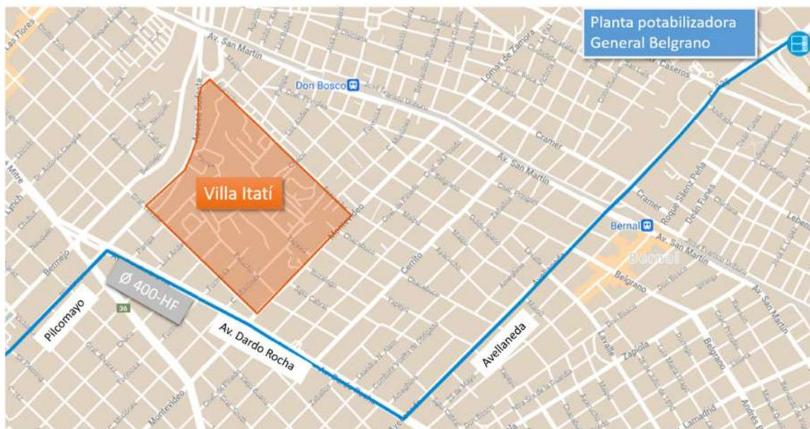
Si se observa el caudal de diseño es de  $Q_f = 173,91 \frac{l}{s}$  implicando como mínimo, tratándose de material PVC, un diámetro de  $\varnothing 400$ .
