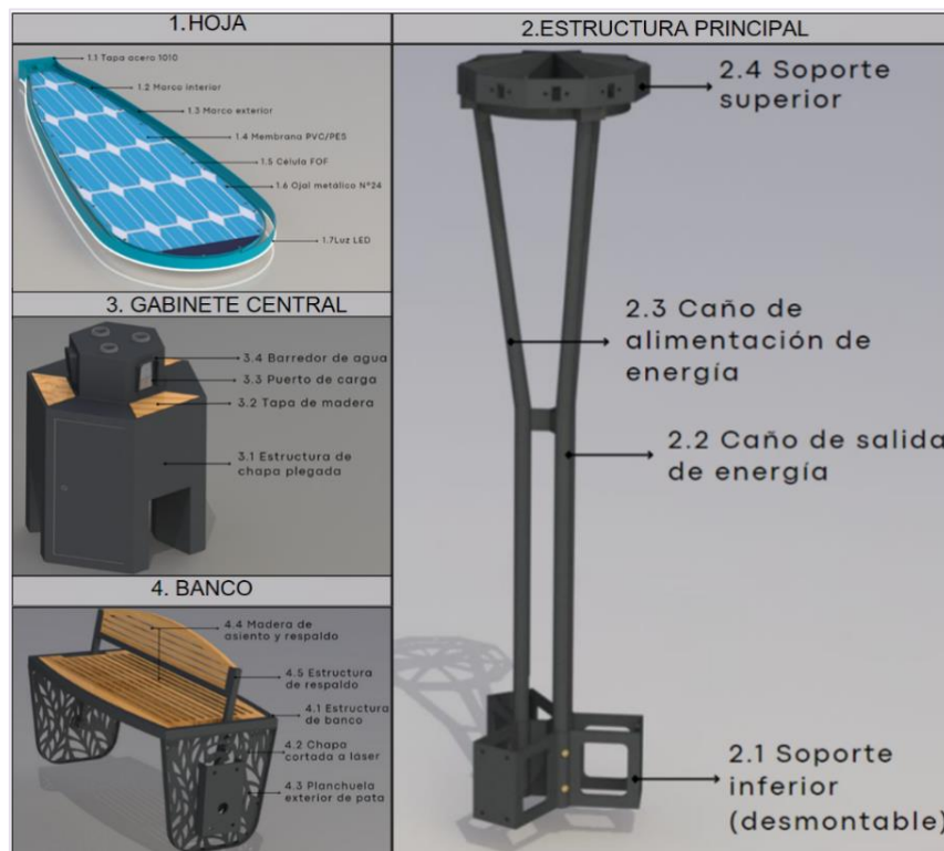
Figura 33: Componentes principales y subcomponentes Fuente: elaboración propia
