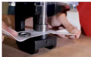
Figura 35: Ejemplo de ojalado de membrana PVC Fuente: imagen tomada de internet
