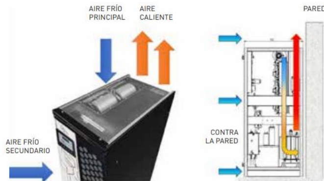
Imagen 3: Ventilación superior y frontal del UPS
