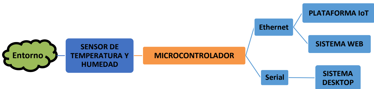
Figura 5. Flujo de información en Termo-Higrómetro.
