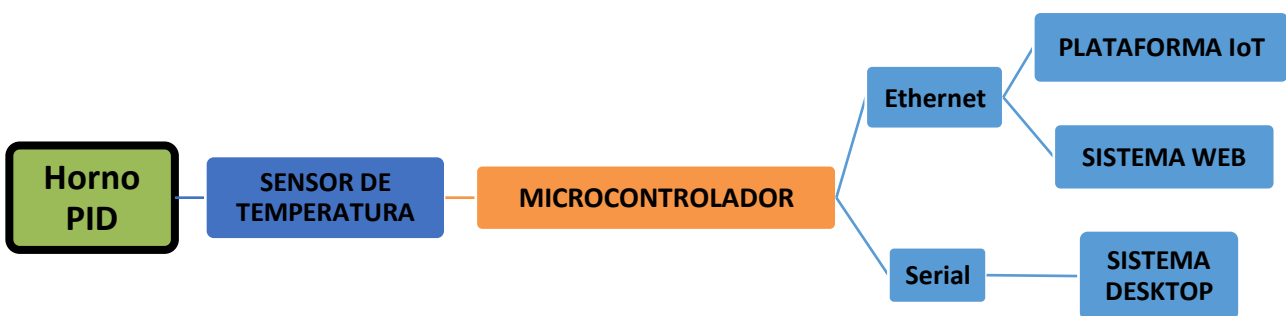
Figura 3. Flujo de información en Horno PID.
