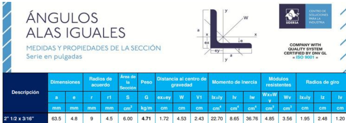
Figura 80 Datos técnicos del perfil utilizado para la estructura soporte de componentes
