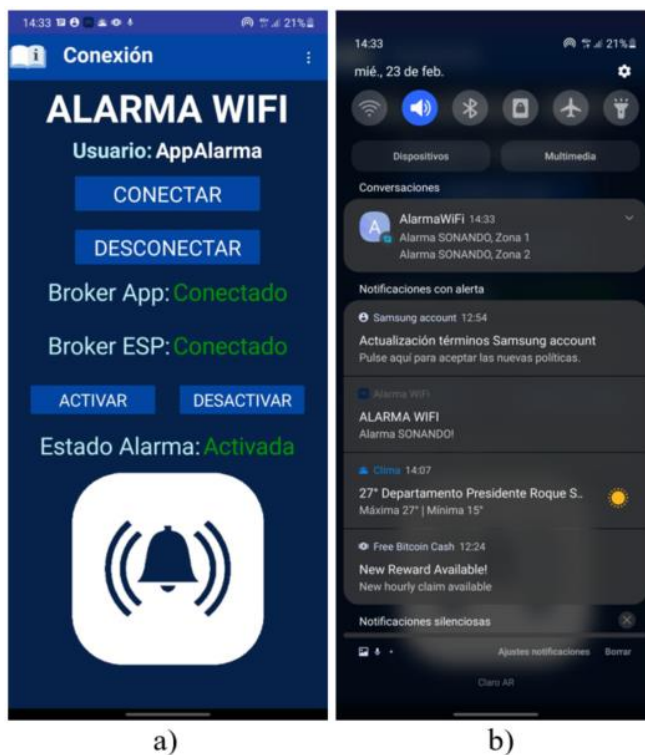
Figura 41: a) Pantalla Conexión con notificación por imagen b) Notificación avisando que la alarma suena y mensajes de texto sobre las zonas.
