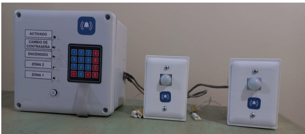
Figura 51: todo el sistema de alarma en la imagen
