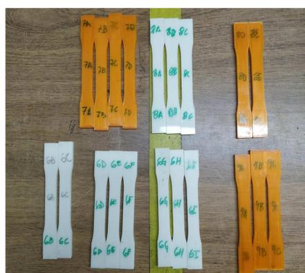
Fig. 1 – Probetas antes del ensayo a tracción
