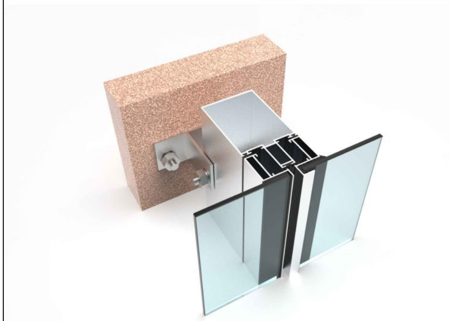
Figura 6-10: Detalle del perfil de cerramiento adoptado
