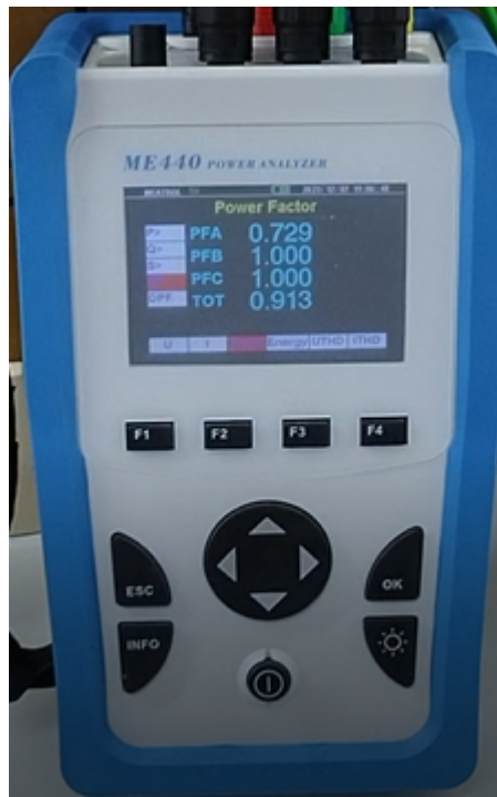
Figura 5.14: Captura del analizador de redes, para contrastar mediciones.
