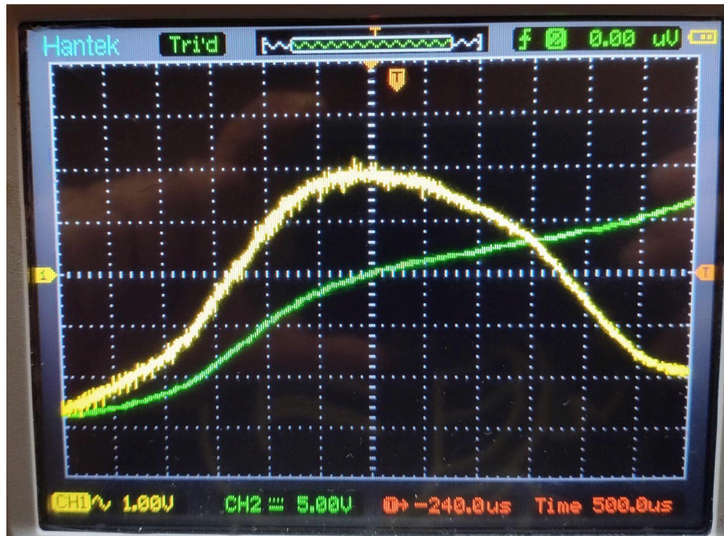
Figura 4.6.b: Desfasaje de tensión 220 VAC (verde) y tensión 6 VAC (amarilla) de los transformadores de tensión.
