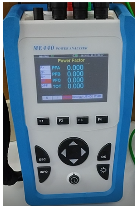
Figura 5.10: Captura del analizador de redes ME440.
