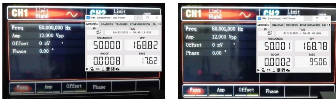
Figura 3. Ensayo frecuencia, (izq) 50.000 Hz y (der) 50.001 Hz.
