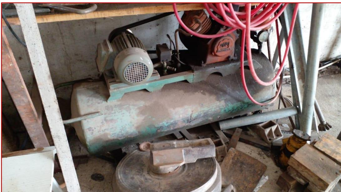
Figura 26 – Compresor de aire utilizado en el depósito
