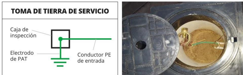
Figura 12 – Detalle de la instalación de PAT de servicio
