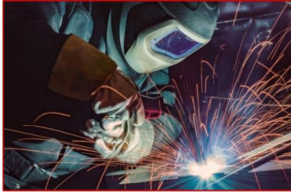
Figura 14 – Proceso de soldadura por arco
