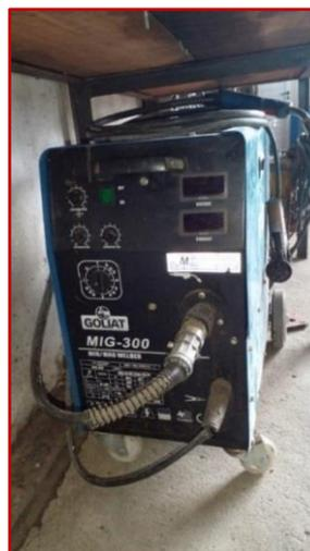
Figura 21 – Equipo de soldadura MIG utilizado
