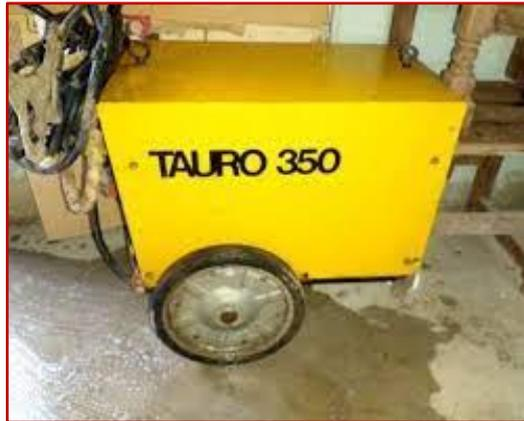
Figura 18 – Equipo de soldadura eléctrica por arco utilizado
