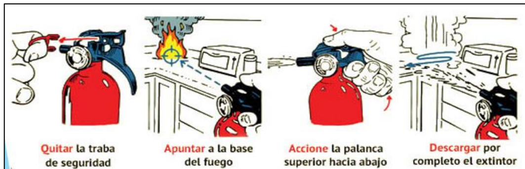
Imagen 16 Uso correcto de extintor, Bienestar 2023
