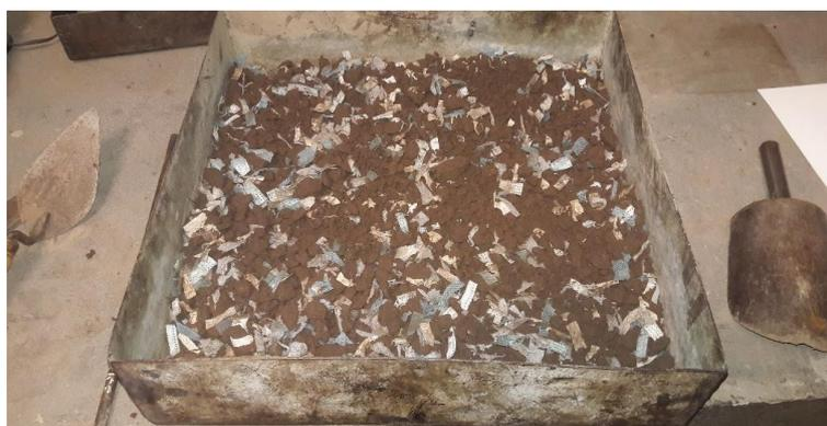
**Figura 1.** Mezclas de suelo y barbijo triturado en laboratorio
