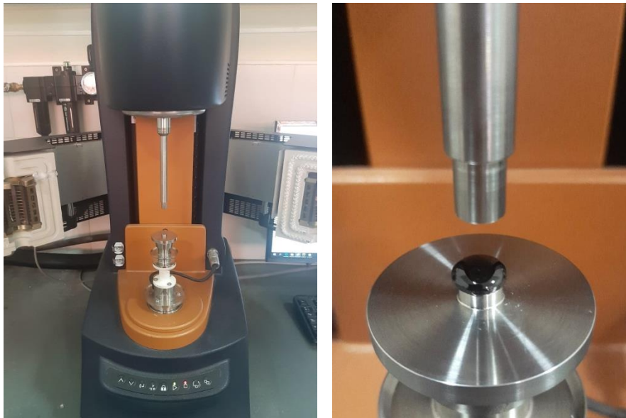
Figura 1. Reómetro de corte utilizado (izq.) geometría de 8 mm junto con la muestra a evaluar (der.)
