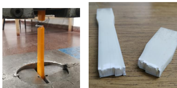
Figura 5 : Aspecto final de la rotura de las probetas luego de efectuado el ensayo.
