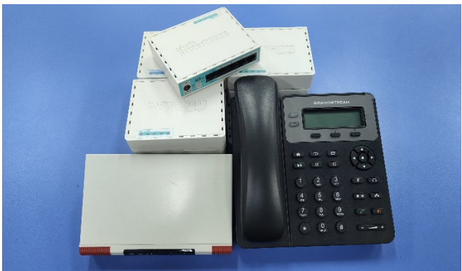
Figura 3. Routers Mikrotik, central telefónica y teléfono IP (parte del equipamiento usado en las prácticas).
