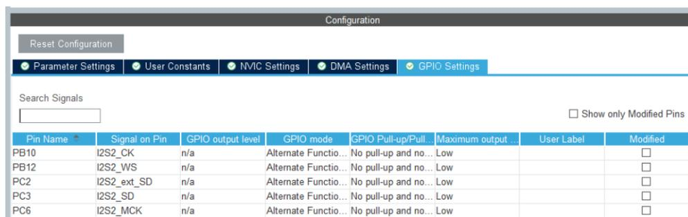
Figura 59 - Configuración de GPIO's I2S
