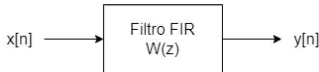
Figura 23 - Arquitectura conceptual para el modo de filtrado
