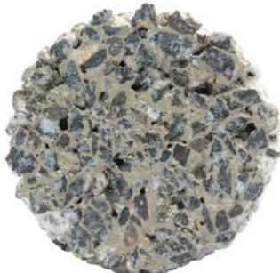
Figura 10: Sección transversal-dosificación C
