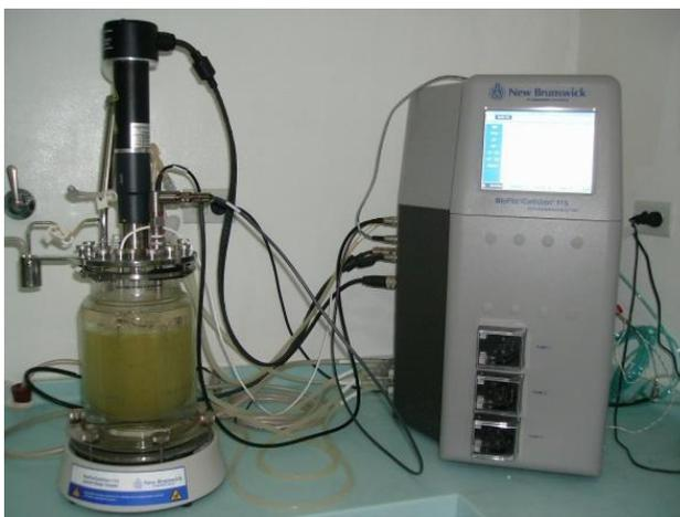
**Figura 25.** Biorreactor y sistema de control utilizado para el cultivo del microorganismo (*BioFlo 115*, *New Brunswick Scientific Co.*).
