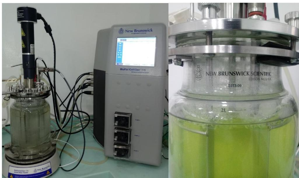
**Figura 39.** Izquierda: Esquema experimental utilizado. Derecha: A los 4 días de cultivo se observa gran producción de espuma por sobre el medio de cultivo.
