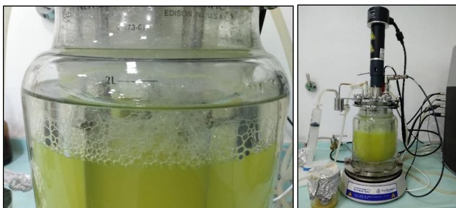
**Figura 46.** Izquierda: Se observa la espuma producida por el cultivo de la cepa *Ag HC*. Derecha: Se observa la configuración experimental con la trampa de espuma.
