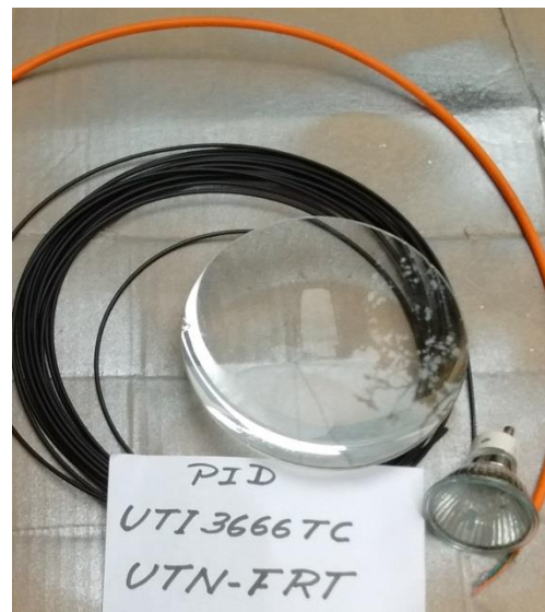
Figura 3 Pruebas con fibras ópticas de cuarzo, lente convergente y luminaria dicróica.
