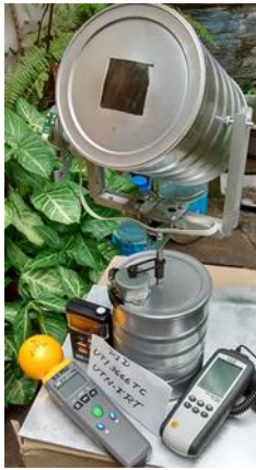
Figura 7 Prototipo de mecanismo de seguimiento solar. Control electrónico. Instrumental.
