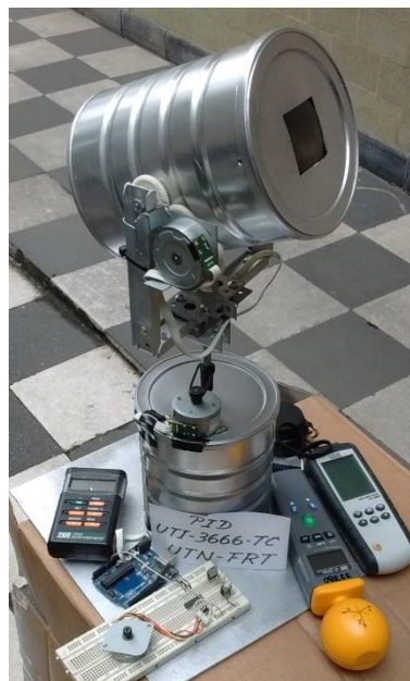
Figura 6 Prototipo de mecanismo de seguimiento solar. Control electrónico. Instrumental.
