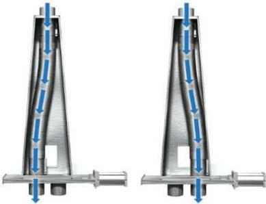
Imagen 24 - Válvula Div. de Manguera Flexible
