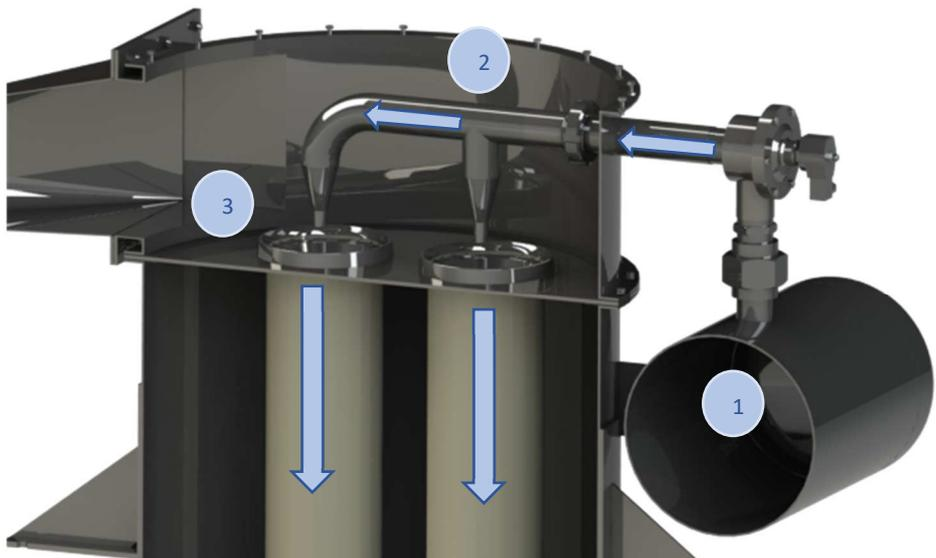
Imagen 41 - Nodos de cálculo de pérdida de carga para soplado
