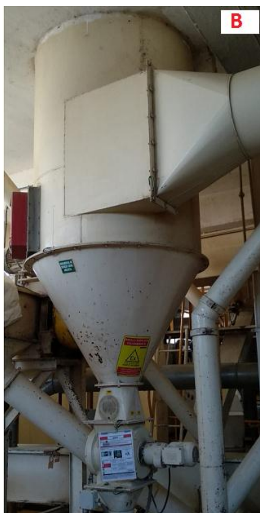
A - Foto filtro de mangas (2do piso) B - Foto descarga filtro de manga y válvula rotativa (1er piso)
