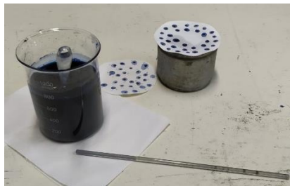
Figura 6. Ensayo de adsorción de Azul de Metileno
