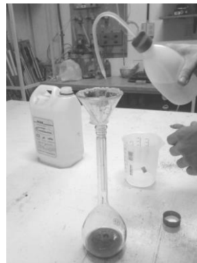
Figura 3. Colocación del espécimen en matraz 500ml
