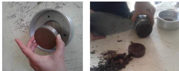
Figura 5. Izq.: Espécimen moldeado en el aro de ensayo. Der.: Extracción del espécimen E1-1I del cilindro sacamuestras
