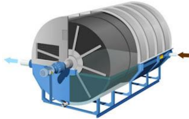
Fig.52: Ilustración de un Contactor Biológico Rotativo (Cyclus, 2021).
