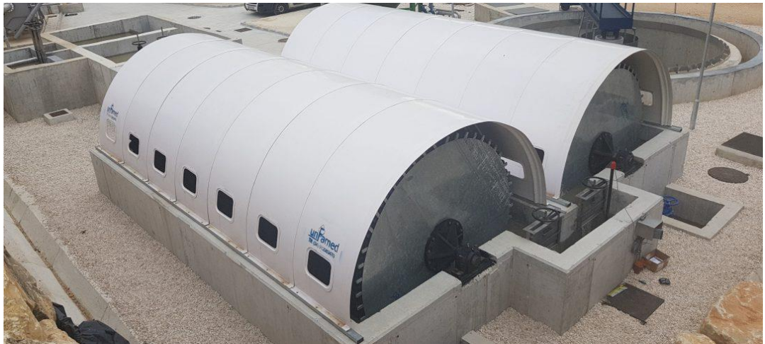
Fig.53: Contactor Biológico Rotativo industrial (Cyclus, 2021).
