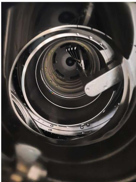
*Figura 29 Interior del recipiente luego de una limpieza completa*
