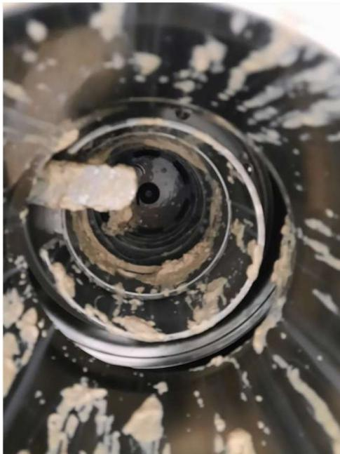
*Figura 28 Interior del recipiente luego del proceso de raspado húmedo (scrape)*
