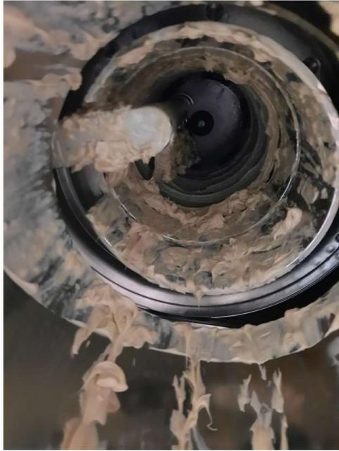
*Figura 27 Interior del recipiente luego del proceso de raspado (scrape)*
