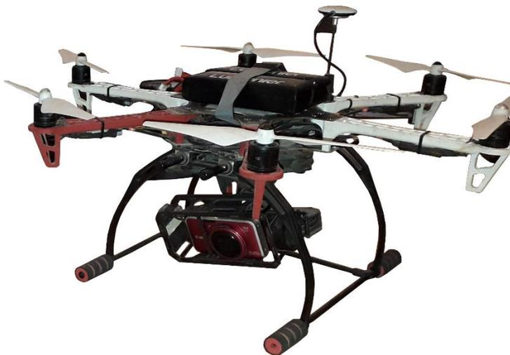
*Ilustración 2 - DJI Flame Wheel F550*
