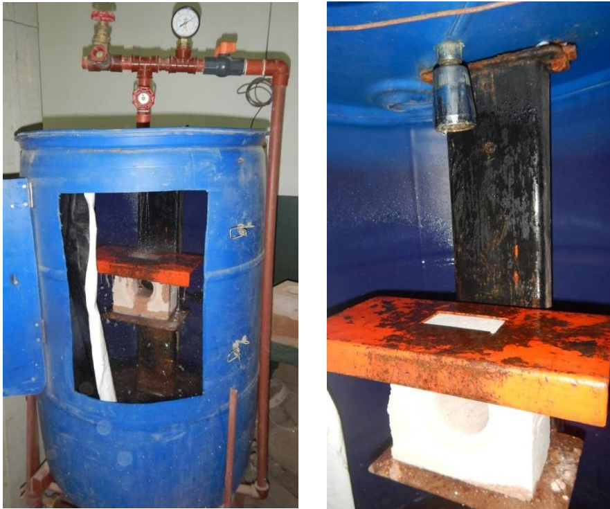
Figura 2. Ensayo de evaluación del nivel de erosión húmeda
