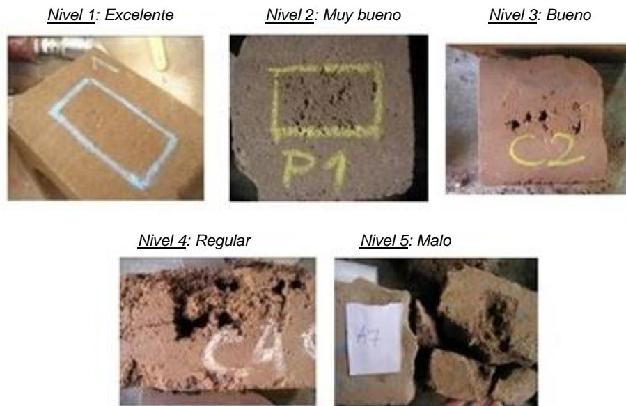
Figura 3. Patrones de comparación empleados por el laboratorio de geotecnia de la UTN – FRFS en la determinación el nivel de resistencia erosión húmeda
