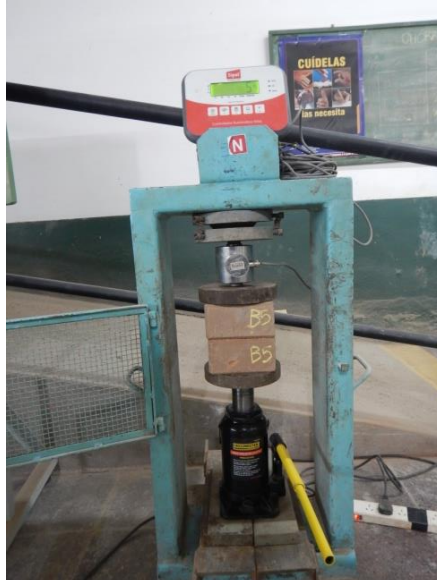
Figura 1. Ensayo de resistencia a compresión
