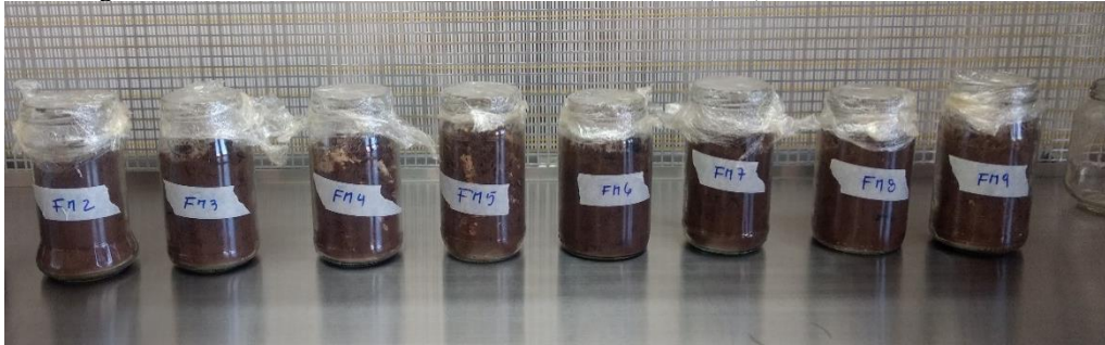
Figura 4. Sistemas microcosmos diseñados en frascos (FM) con suelo contaminado.
