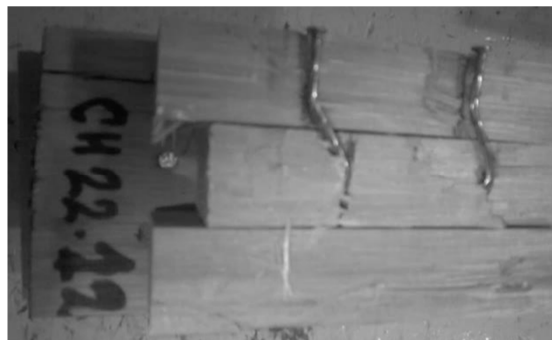
Figura 2. Cuerpo de prueba abierto luego del ensayo
