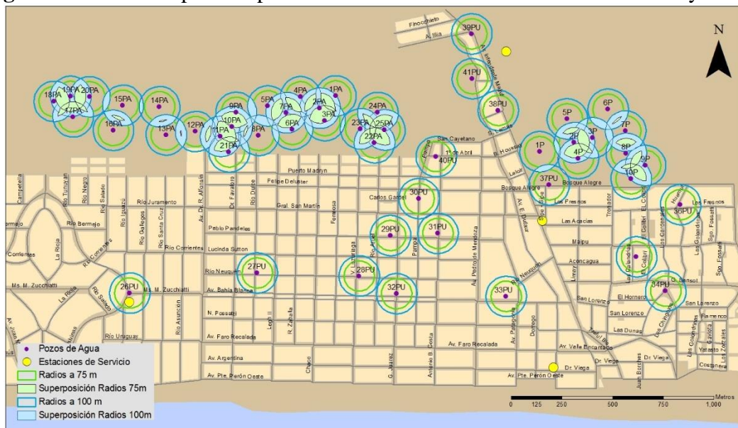
Figura 8. Escenarios para las perforaciones con radios de influencia de 75 m y 100 m.
